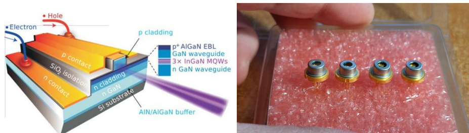
Fig. 6: Diodo láser semiconductor con diseño y producción únicos, desarrollados por el Laboratorio UltraSmart
