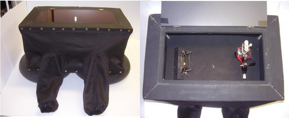
Figura 4: Instalación experimental portátil diseñada para la obtención de hologramas en la escuela y en la casa
