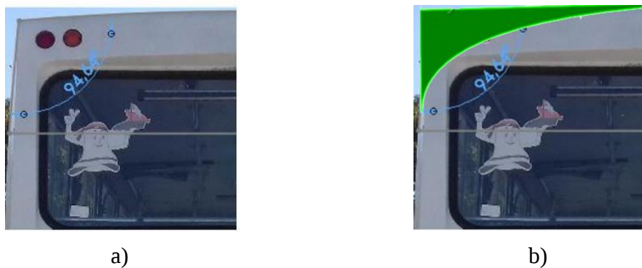
Fig.3 Sección transversal del ómnibus; a) Modelo original y b) Área retirada en el modelo propuesto.
