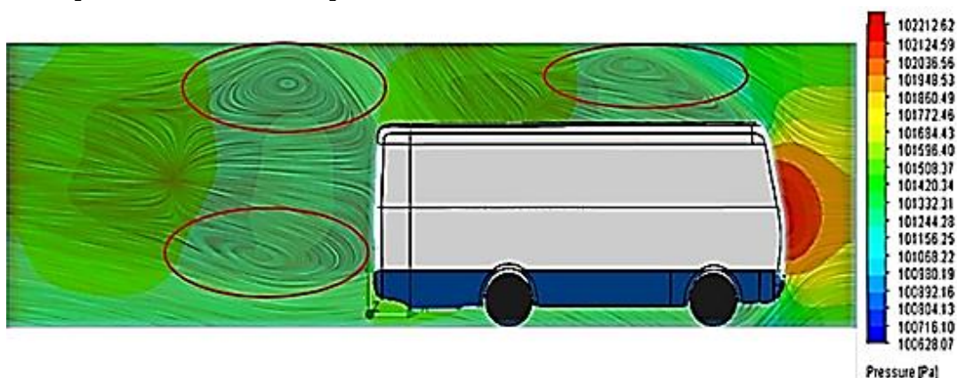
Fig.6 Patrón de flujo de aire alrededor de la carrocería del ómnibus del modelo original a una velocidad de desplazamiento de 90 km/h
