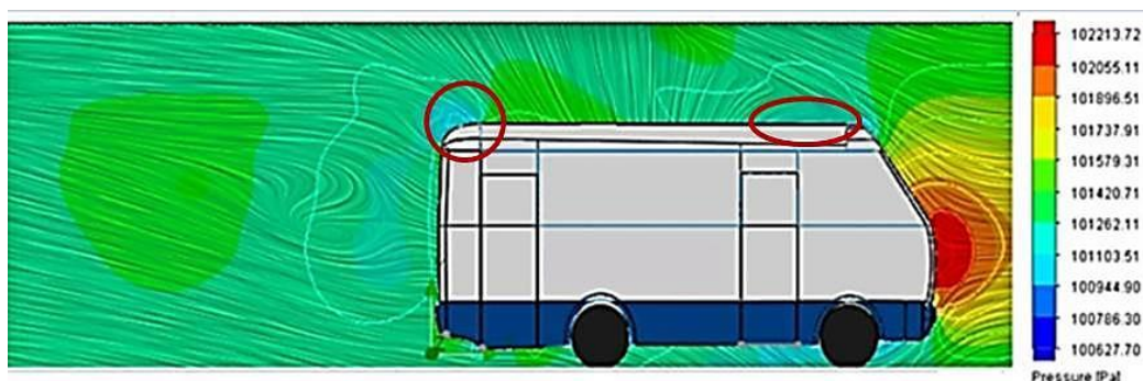
Fig.7 Patrón de flujo de aire alrededor de la carrocería del ómnibus del modelo con modificaciones a una velocidad de desplazamiento de 90 km/h
