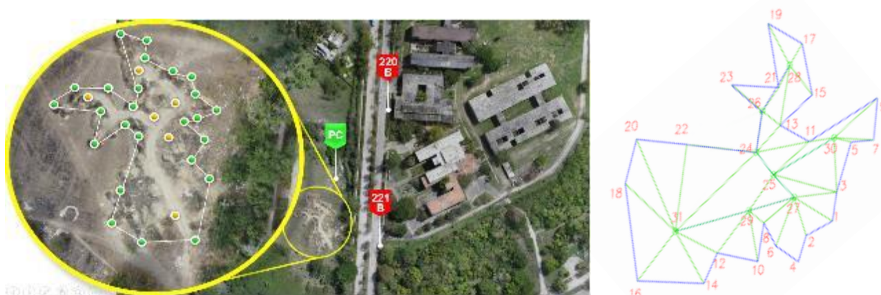
Fig.7 Polígono replanteado por métodos tradicionales (izquierda) y Polígono resultante de las mediciones topográficas en el software AutoCAD (derecha)
