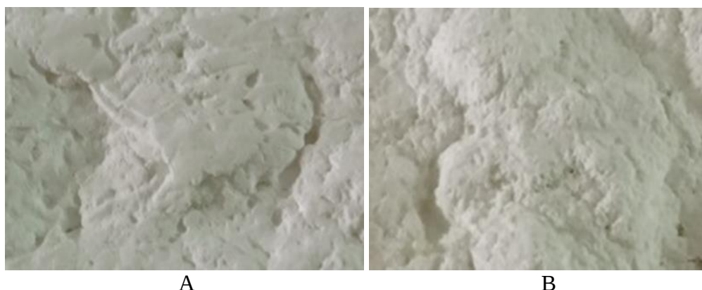
Fig.7 Corte realizado a una sección de cada uno de los andamios. A- andamio de crestas, B- andamio de piel de cerdo
