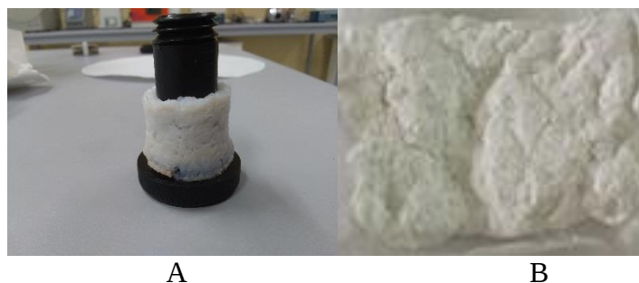
Fig.6 Andamios resultantes del proceso de liofilización del colágeno. A- andamio de crestas de pollo, B- andamio de piel de cerdo
