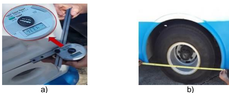
Fig.2 Mediciones realizadas a la carrocería del ómnibus DIANA modelo GD.01C; a) Medición con goniómetro digital y b) Medición con cinta métrica
