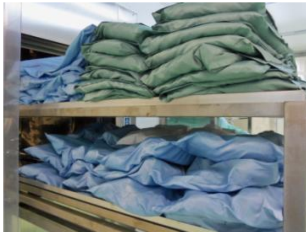
Fig. 3. Posicionamiento anterior de las cargas en el interior de la autoclave
