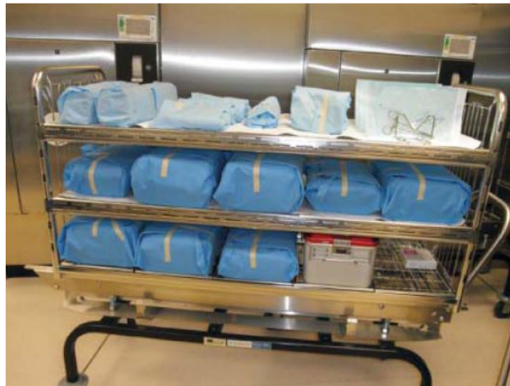
Fig. 4. Posicionamiento actual de las cargas en el interior de la autoclave, Fuente: Steris
