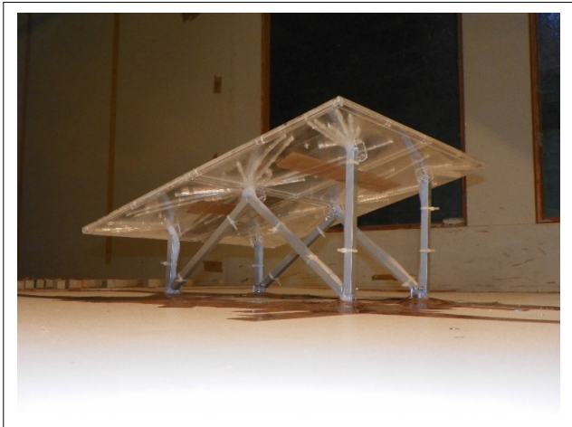
Fig. 9. Modelo a escala reducida con toda la instrumentación colocada por las columnas de la estructura.
