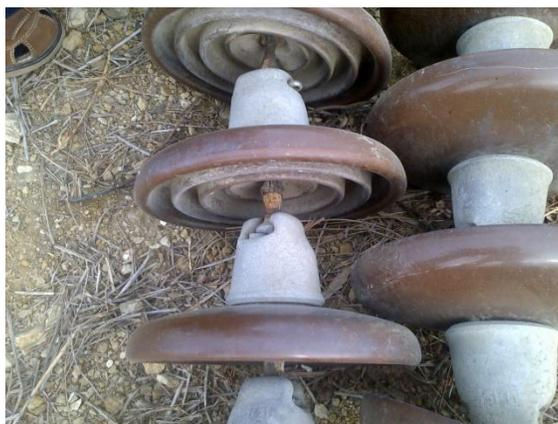
**Fig. 3. Muestra de los aisladores deteriorados por la contaminación**
