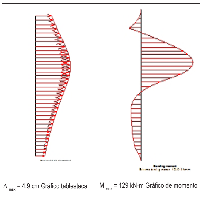
Fig. 2. Deformada y momentos en la tablestaca.
