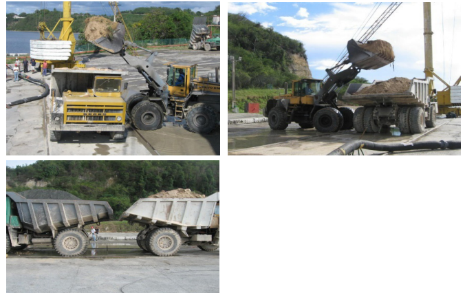
Fig. 7. Prueba de carga con camión Belaz, carga de dos camiones.
