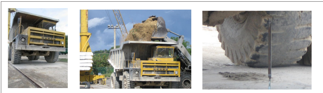
Fig. 6. Prueba de carga con camión Belaz, carga de un camión.
