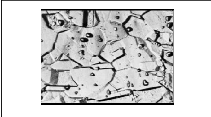
Fig. 6. Estructura de pasos. Solo se presentan pasos entre los granos, no hay zanjas en los límites de grano (500x de aumento)
