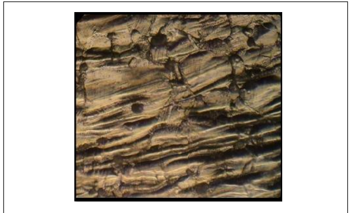
Fig. 9. Muestra pulida sin tratamiento térmico y con ataque electroquímico en presencia de ácido oxálico (500x de aumento)
