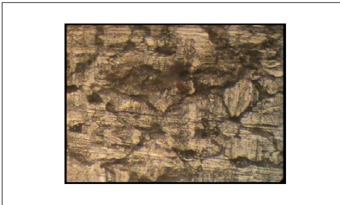
Fig. 10. Muestra pulida con tratamiento térmico y con ataque electroquímico en presencia de ácido oxálico (500x de aumento)
