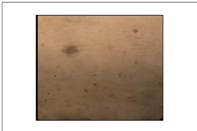
Fig. 2. Muestra sin tratamiento térmico, ni ataque con reactivos (500x de aumento)
