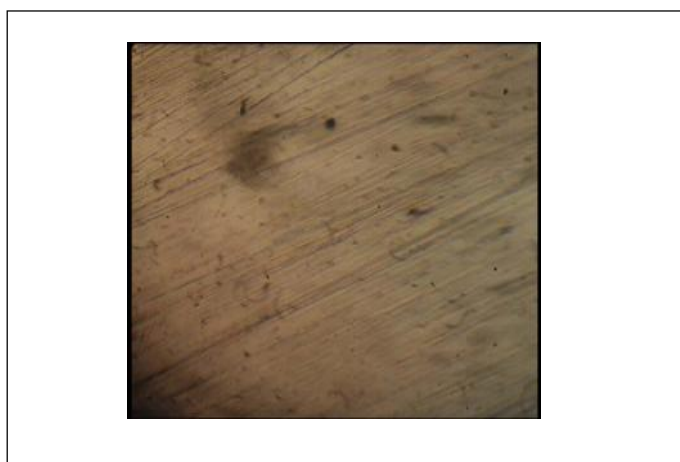
Fig. 4. Muestra sin tratamiento térmico, con ataque electroquímico en presencia de la solución de KOH (500x de aumento)
