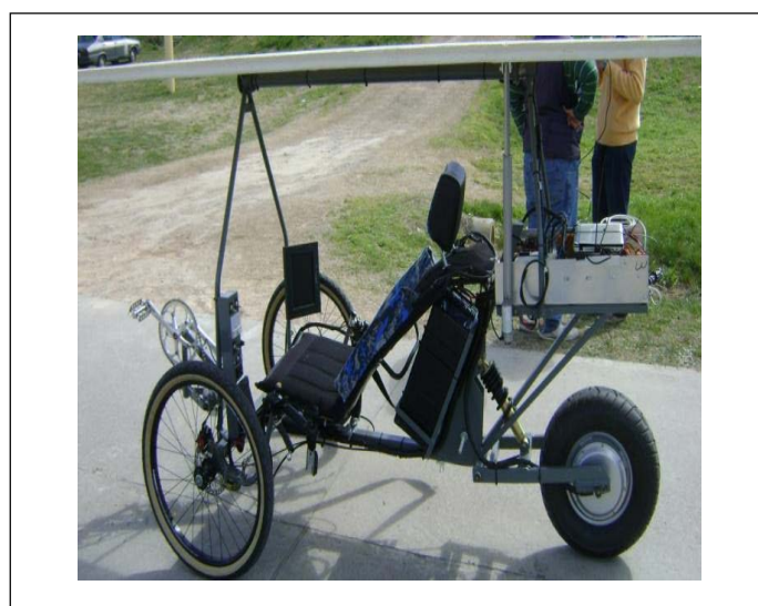
Fig. 4. Imagen del vehículo Pampa Solar sin carrocería
