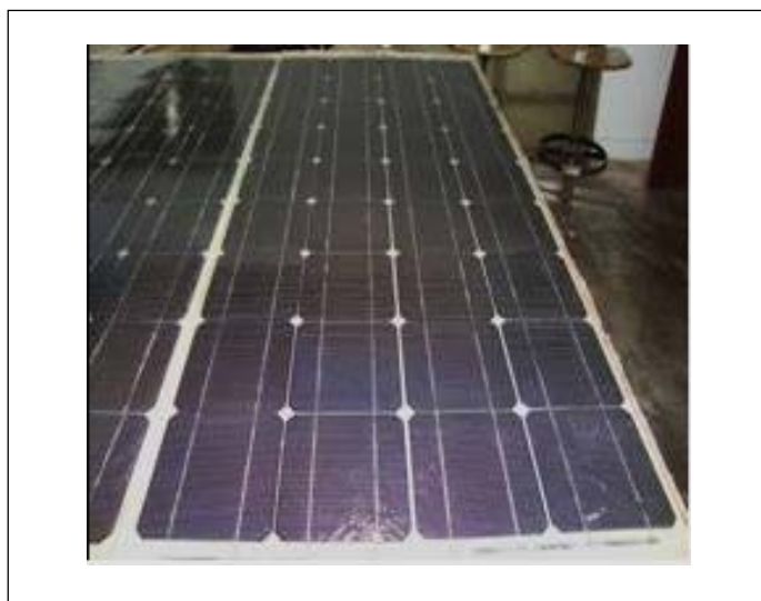
Fig. 6. Fotografía de las celdas solares interconectadas y encapsuladas en los paneles solares
