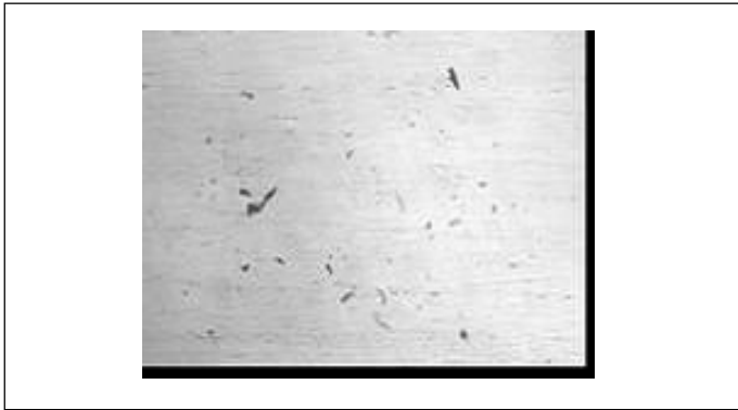
Fig. 2. Corrosión en el acero del enfriador en una zona de la muestra por donde fluye la solución de limpieza química después del desbaste y pulido 200X
